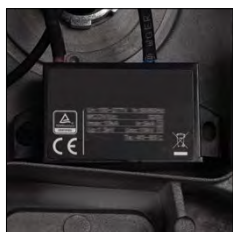
beépített SPD túlfeszültség-védelemmel
